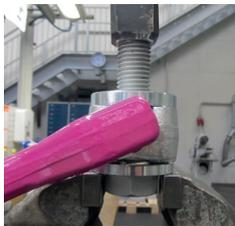
Fig. 10 : Placement de l'ACP pour le démontage de la vis
