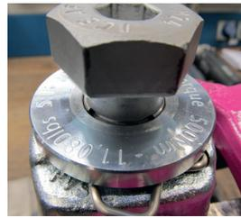
Fig. 12 : Bague d'écartement enfoncée dans le chanfrein
