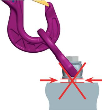
Fig. 5 : L'anneau de levage doit être entièrement vissé.
